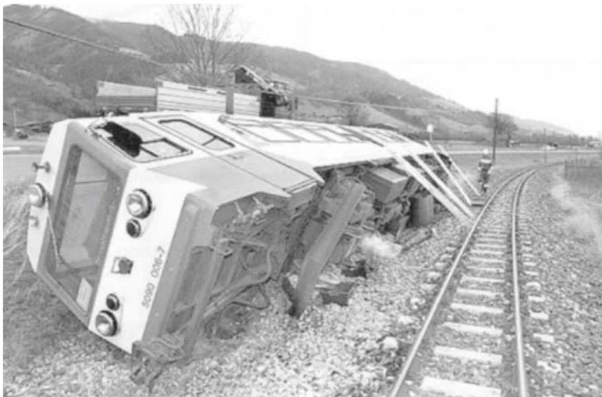
Abbildung 1.1: Umgestürzter Zug auf Grund der Einwirkung einer Windböe [74]
