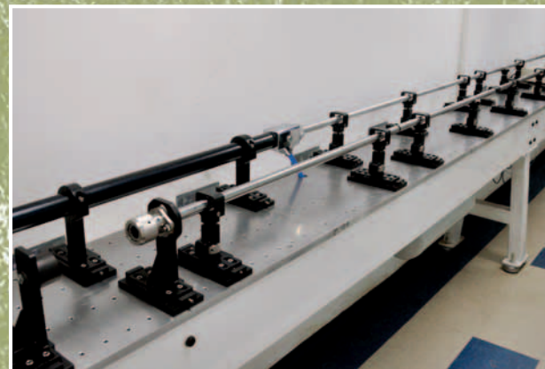
Im Rahmen des deutsch-brasilianischen Forschungsprojekts werden Aluminiumbauteile verschiedenen Belastungstests unterworfen
