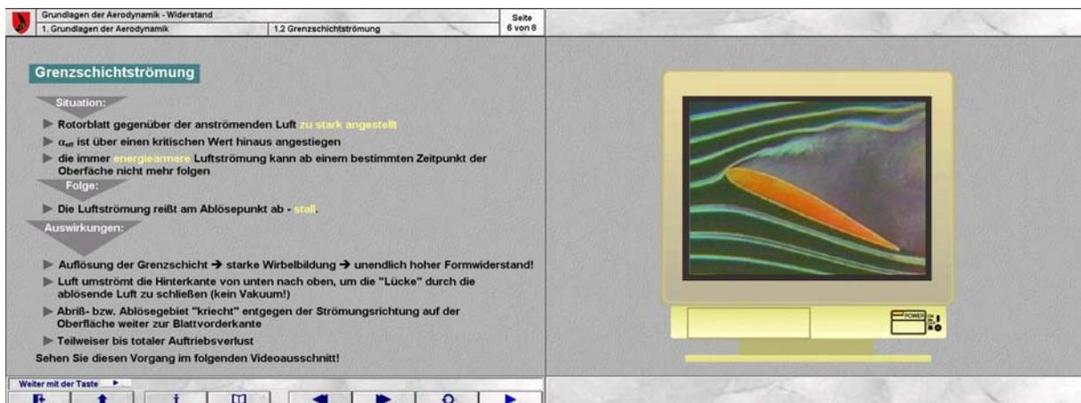
(Abb. 13: Momentaufnahme Strömungsabriss)
