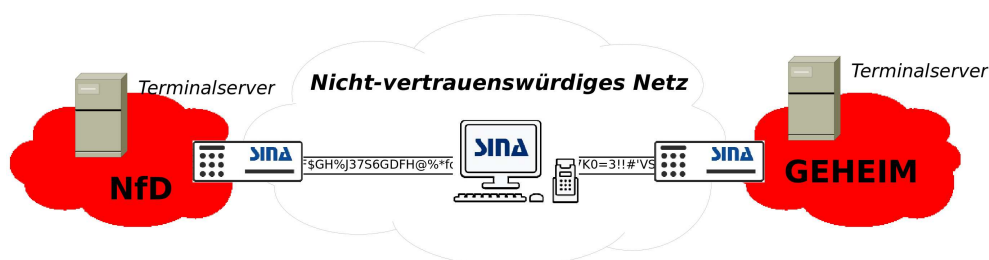
Abbildung 3.8: Nutzung verschiedener Sessions unterschiedlicher Einstufung auf einem ThinClient
