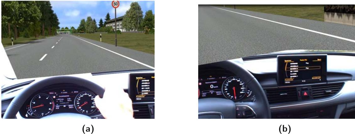
**Abbildung 7.7:** Fahrersicht im VIL mit AR-Visualisierung auf Basis von „video-see-through“
