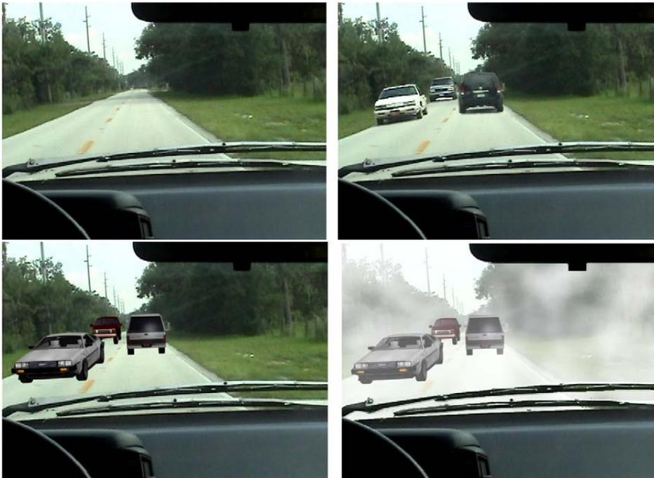
**Abbildung 2.12:** Oben: Kamerabilder der realen Szene. Unten: Kamerabild mit virtuellen Fahrzeugen links und rechts mit Nebel zusätzlich überlagert. (Moussa, Radwan & Hussain, 2012)
