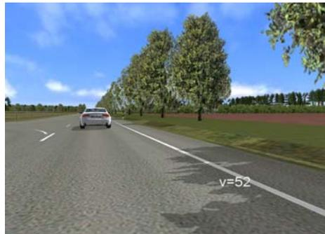
**Abbildung 2.10:** Fahrersicht im VIL mit VR-Modus mit aktivierter Geschwindigkeitsanzeige
