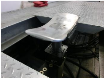
a) Radschale mit innenliegenden Bördelung der 4-Stempel-Anlage 1
