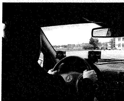
Bild 2: System zur berührungslosen Blickfassung (faceLAB)
