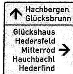
Bild 12: Beispiel für Schild mit 2 Richtungen mit maximal 7 Zielen, davon 5 in einer Richtung
