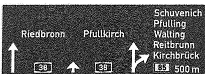
Bild 7: Beispiel einer Auslegung mit 7 Zielen, 2 geradeaus und 5 abzweigend
