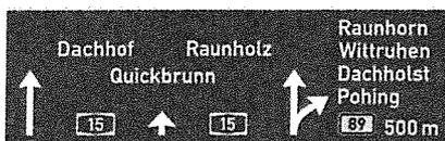
Bild 6: Beispiel einer Auslegung mit 3 Zielen geradeaus und 4 abzweigend
