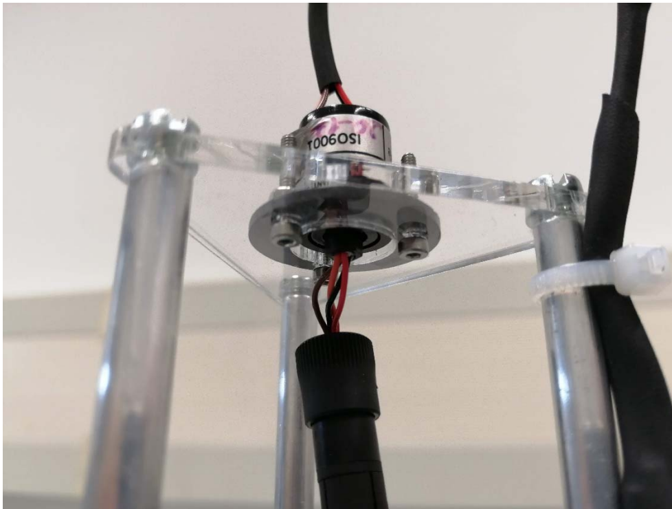
Abb. 6: Schleifringübertrager zur Verbindung mit dem Messverstärker
