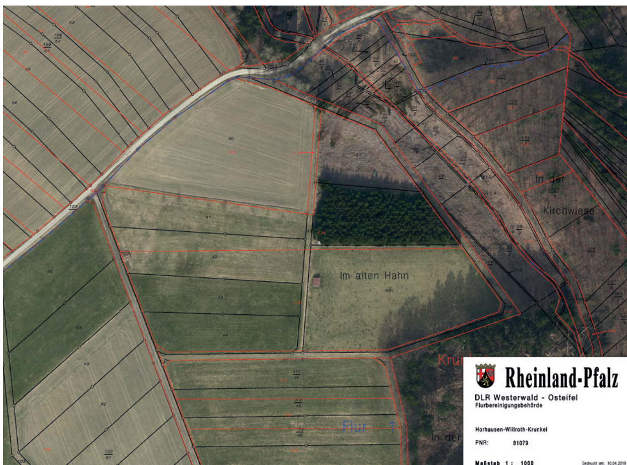
Abb. 4 | Verlegung einer Ausgleichsfläche zur Vermeidung von Unformen. Im aktuellen Luftbild ist der alte Bestand (AB) vor der Neuordnung in Schwarz und der im Flurbereinigungsplan vorgesehene neue Bestand (NB) nach der Neuordnung in Rot dargestellt. In Blau ist auch die alte Flurgrenze und Flurbezeichnung wiedergegeben.
