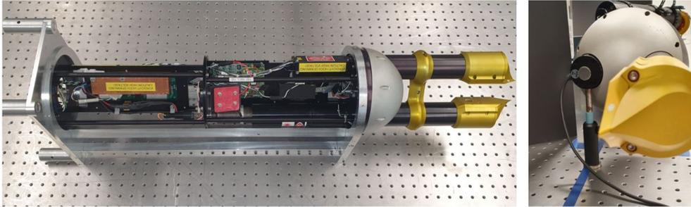
Abbildung 3.6: Im linken Bild ist die FFSSP ohne Abdeckung zu sehen. Hinter dem unteren Messarm ist das schwarze Laserrohr zu erkennen. Auf dem rechten Bild ist der Aufbau zur Messung der Laserleistung mit einem Powermeter zu sehen. Der Messarm vor dem Laser wurde dazu abgebaut.
