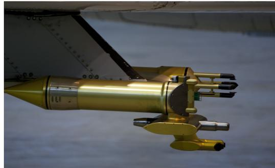
Abbildung 3.13: Steuerbordseitige Tragflügelstation an der DC-8. Die CAS ist das Instrument mit dem silbernem Einlassrohr. CC-BY: DLR.
