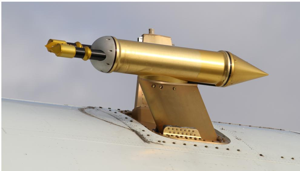
Abbildung 3.4: Fast Forward Scattering Spectrometer Probe (FFSSP). Die beiden schwarzen Messarme zeigen in Flugrichtung und sind mit zwei goldenen Korolev-Spitzen ausgestattet. CC-BY: DLR.
