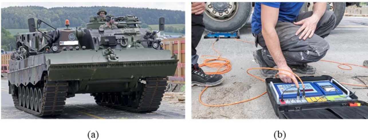
Abbildung 7: (a) Panzer als Versuchsfahrzeug an der Versuchsbrücke (b) Mobile Achslastwaage
