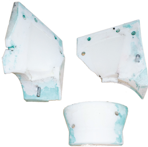
(a) Schaufel-Negativformen zur CFK-Fertigung mit blauen Trennmittelrückständen und deutlichen Abnutzungsspuren aufgrund mehrfacher Nutzung
