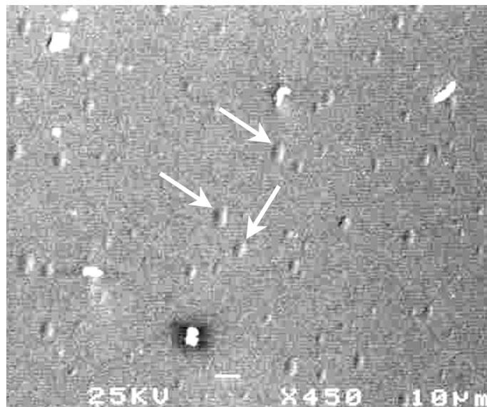
*Abbildung 4.11: REM Aufnahme von direkt auf Siliziumnitrid abgeschiedenen 100 nm dicken Platin. Die Blasenbildung ist deutlich zu erkennen (Beispiel: Pfeile).*
