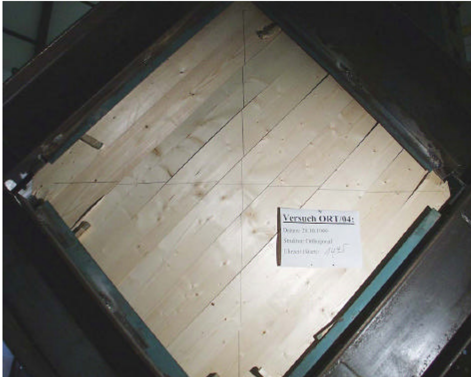
Bild 4.8: Schubverformungen im mittleren Bereich bei weitgehend intaktem Kräfteinleitungsbereich am linken und rechten Gelenk des Viergelenkrahmens
