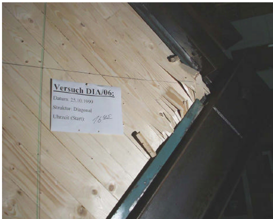
Bild 4.14: Versagen im Kräfteinleitungsbereich (DIA 06)
