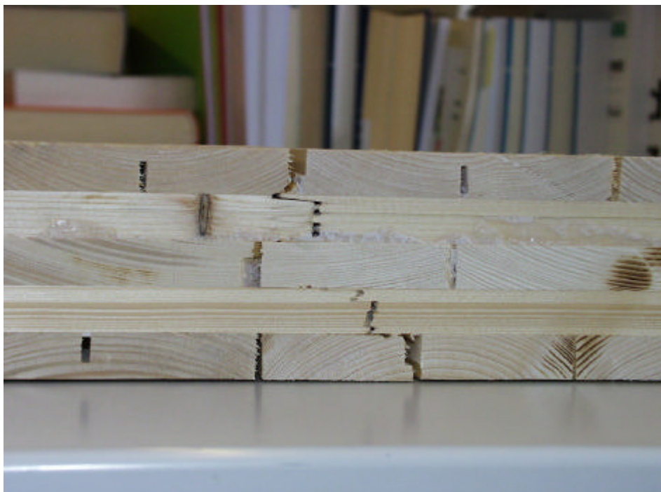
Bild 4.30: Biegebruch in den horizontalen Brettlagen 2 und 4
