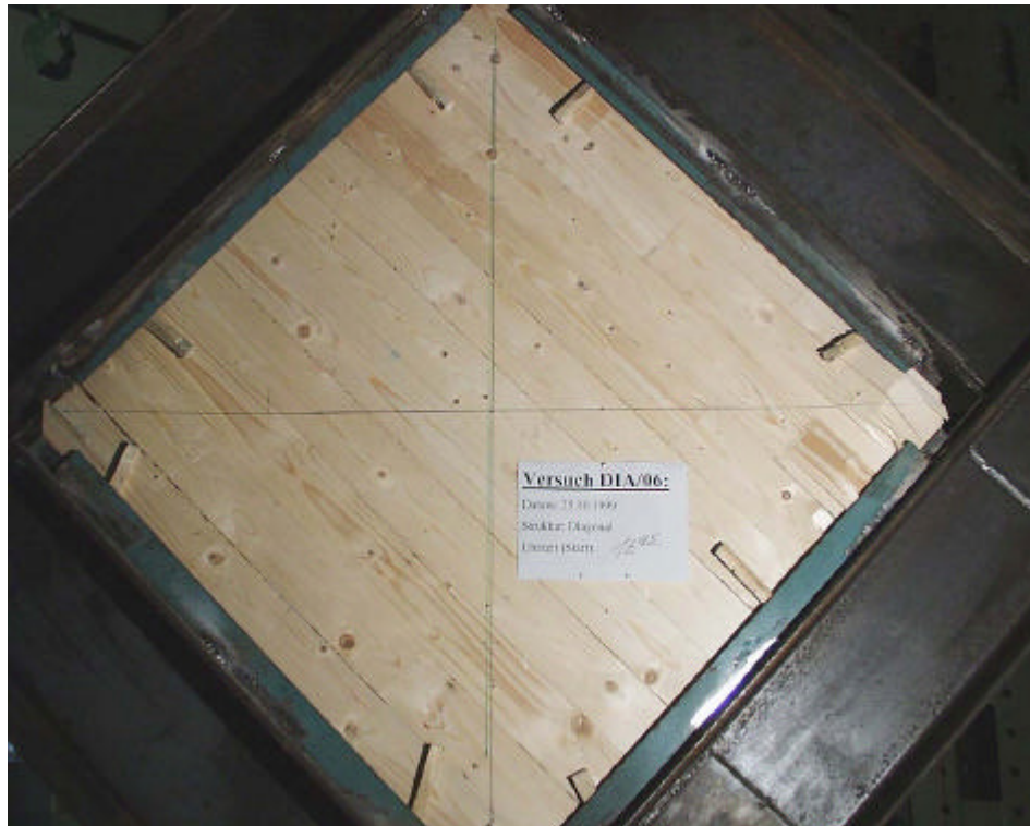
Bild 4.13: Probekörper aus Brettlagenholz mit diagonaler Struktur im Bruchzustand ohne Schubverformungen im mittleren Bereich (DIA 06)
