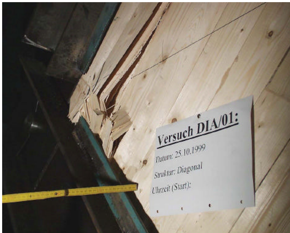
Bild 4.12: Versagen im Kräfteinleitungsbereich (DIA 01)
