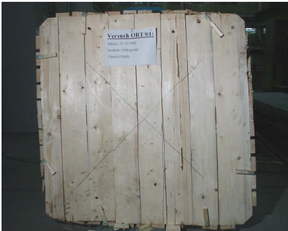
Bild 4.9: Seitlich aufgenagelte Bretter am Probekörper ORT 01 im ausgebauten Zustand nach Versuchsende
