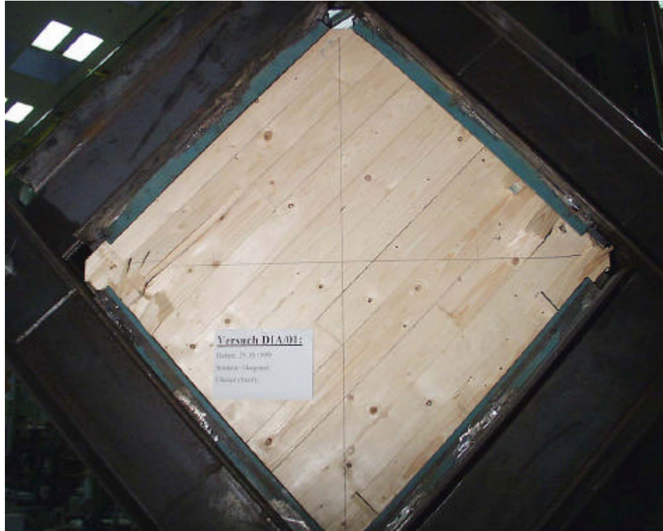
Bild 4.11: Probekörper aus Brettlagenholz mit diagonaler Struktur im Bruchzustand (DIA 01)
