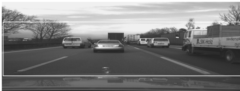
Abbildung 4.20: Originalbild einer typischen Autobahnszene. Der überlagerte weiße Rahmen begrenzt den auszuwertenden Bildausschnitt.
