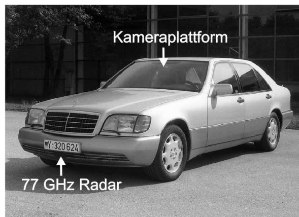
Abbildung 6.2: Versuchsträger für autonome Mobilität im Pkw - VaMP
