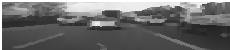
Abbildung 4.26: Rekonstruktion des Bildes bei Verwendung einer 8x8-Elementarmaske und Schrittweite 8 zwischen den vertikalen Suchpfaden.
