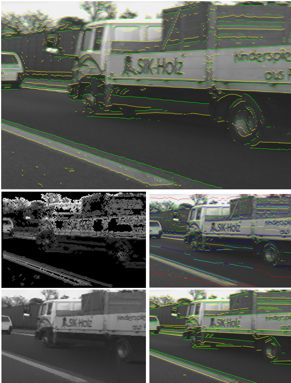
Abbildung 4.30: Vertikale Auswertung eines Bildausschnitts mit 1 \times 2 -Elementarmaske und Schrittweite eins: oben) gerichtete Kantenpunkte, Mitte links) L- und R-Werte, Mitte rechts) gerichtete Segmentmittelpunkte, unten links) lineare Rekonstruktion, unten rechts) horizontale Verkettung gerichteter Kantenpunkte entsprechend Abschnitt 4.3.13.1.
