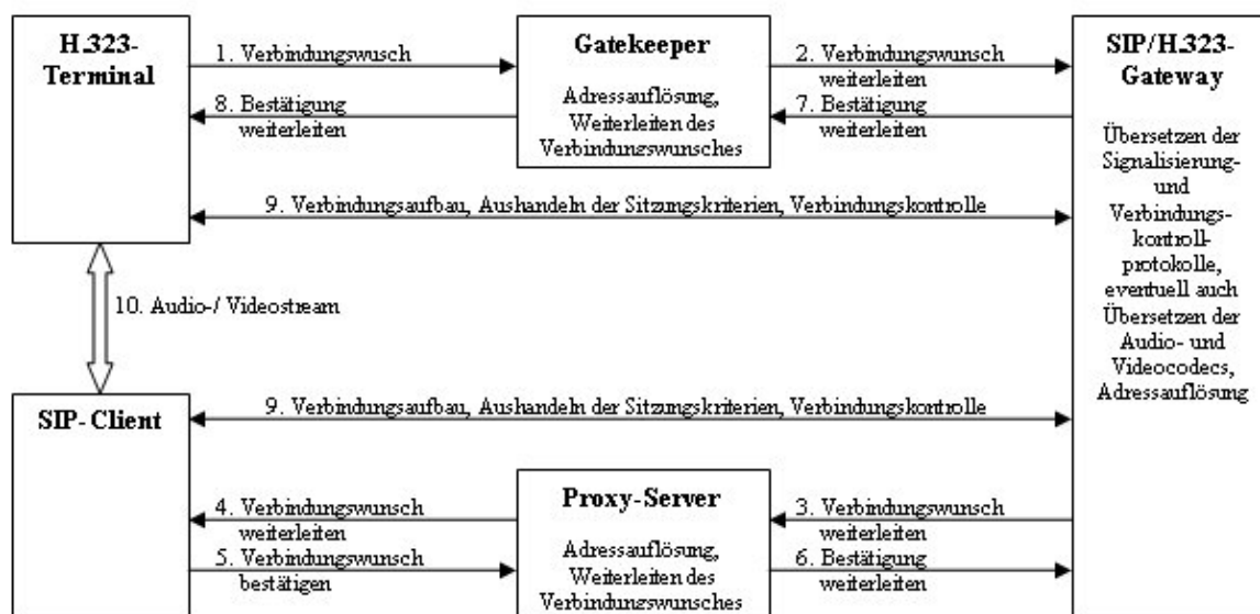
Abbildung 4.18: Verbindungsaufbau H.323-Terminal und SIP-Client
