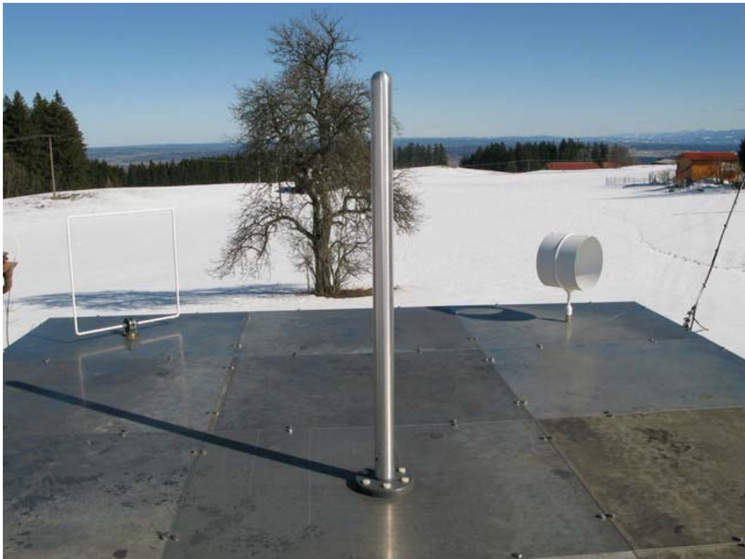
Bild 3.9: Sensoren für das magnetische Feld, die zeitliche Änderung des elektrischen Feldes und die zeitliche Änderung des magnetischen Feldes
